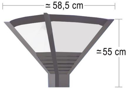
**33.Φωτιστικό Δρόμου LED SMD 150W**, IP66, IK09,4000K, φωτεινή ροή 19.500 lm, χρόνος ζωής 60.000 h, τάση λειτουργίας 100-240V, σώμα ενιαίο κατασκευασμένο από χυτοπρεσσαριστό κράμα αλουμινίου ( Al 12 Si Fe UNE 38269). Σύστημα στήριξης στον ιστό από χυτό αλουμίνιο
